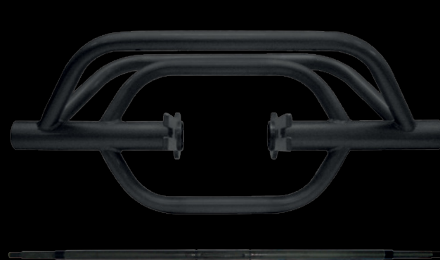
TRICICLO FORMADO POR 2 ESTRUCTURAS ENCAJADAS ENTRE SI, ESTE SISTEMA EVITA QUE EL TRICICLO SE DESPLAZE HACIA EL LADO CONTRARIO AL QUE EFECTUAMOS EL GIRO
